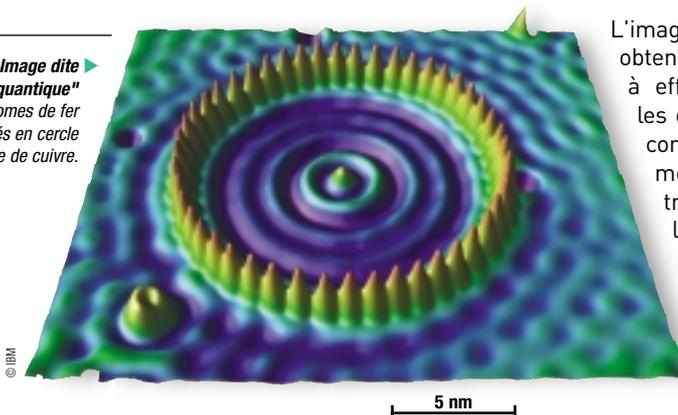
L'image du "corral quantique", obtenue grâce au microscope à effet tunnel, montre que les électrons se comportent comme des ondes : ils forment un nuage concentrique qui ondule comme la surface de l'eau dans laquelle on a jeté un caillou. C'est une des plus remarquables visualisations directes des lois de la mécanique quantique.
