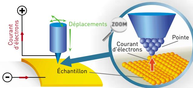
Cet instrument révolutionnaire, initialement conçu pour observer la surface des matériaux, est maintenant aussi utilisé pour déplacer des atomes un par un, comme une "pince à atomes".
