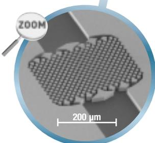
Le laboratoire sur puce est une plaque de verre ou de silicium sur laquelle sont gravés des microcanaux et des microréservoirs dans lesquels circulent le sang à analyser et les réactifs. On dépose à l'entrée de la puce une goutte du prélèvement à analyser. Des dispositifs électriques créent une pres-
