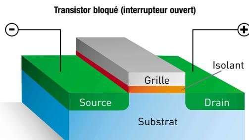
◀ Si l'on supprime la tension appliquée sur la grille, le canal de conduction disparaît et le courant est interrompu.
