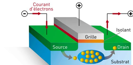
On applique une tension électrique déterminée sur la grille ; un électron supplémentaire peut alors passer dans l'île. Il s'établit alors dans le transistor un courant dont l'intensité dépend du nombre d'électrons présents dans l'île.
