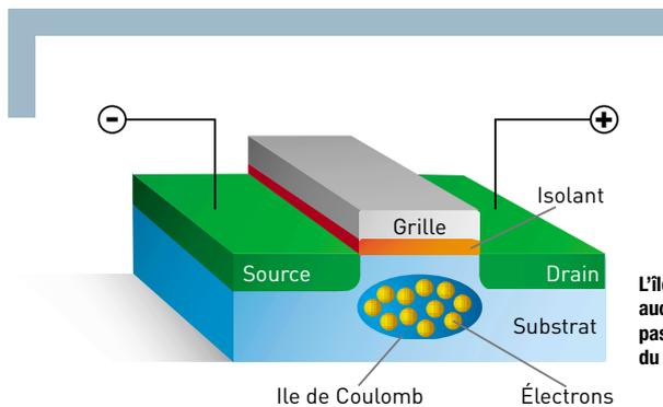
L'île est remplie d'électrons ; aucun électron ne peut plus passer dans l'île en raison du blocage de Coulomb.
