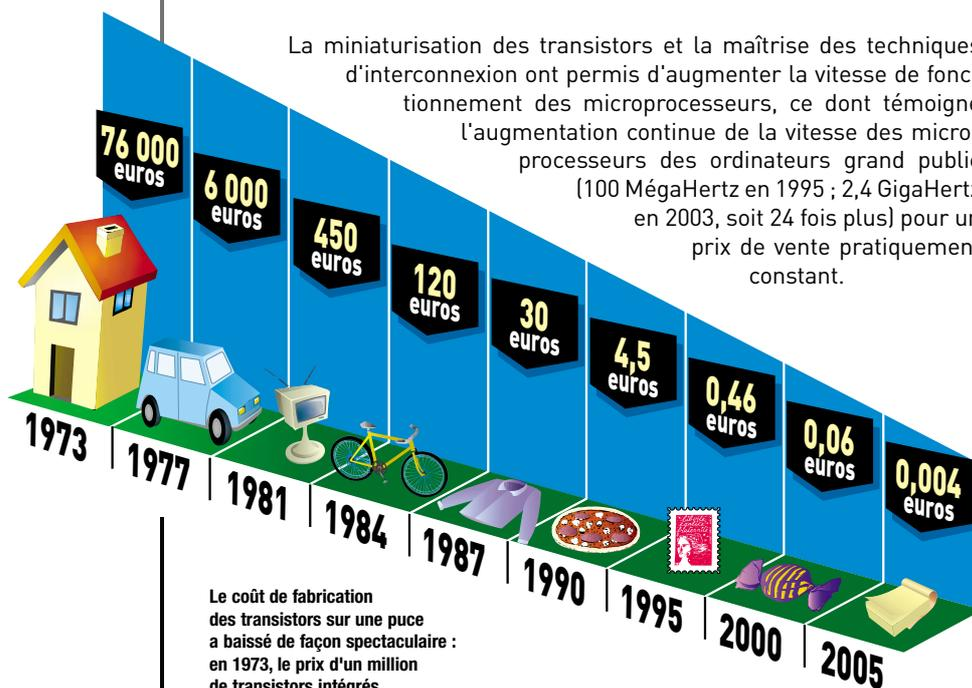
Le coût de fabrication des transistors sur une puce a baissé de façon spectaculaire : en 1973, le prix d'un million de transistors intégrés équivalait à celui d'une maison ; en 2005, il sera celui d'un post-it.
