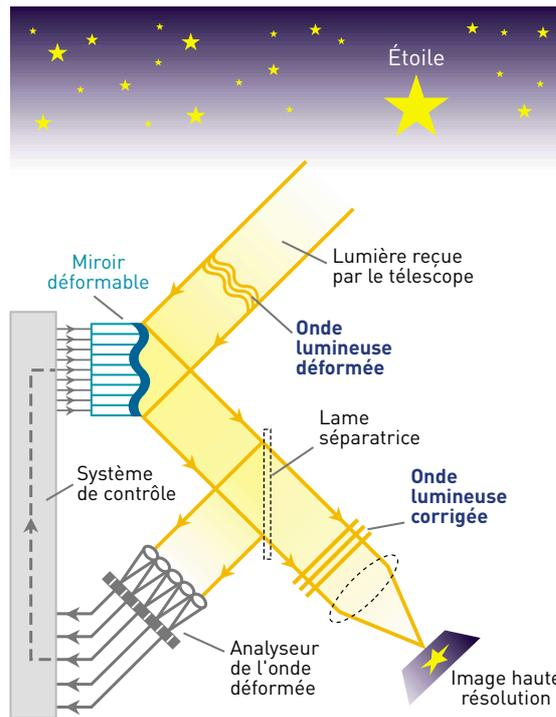
◀ **Le principe de l'optique adaptative :**
