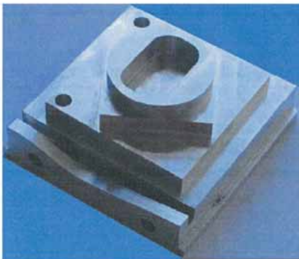
Figures 3 & 4 : exemples de pièces complexes usinées lors des campagnes de test.
