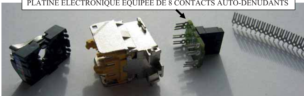
Figure 1 – PHOTOS de la PRISE RJ45 DÉMONTÉE
