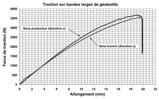
Figure 4. Essais de traction sur bandes larges de géotextile (Géo1).
