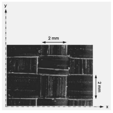
Figure 3. Texture bidirectionnelle du géotextile (Géo1) tissé de bandelettes de polypropylène.
