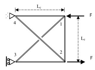
Figure 3: Treillis élémentaire
