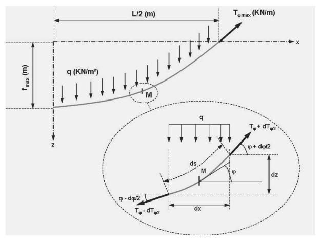
Figure 5. Equilibre d'un tronçon élémentaire de nappe géotextile (Géo1).
