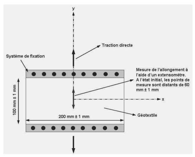
Figure 2. Principe de l'essai de traction directe sur bandes larges de géotextile (Géo1).
