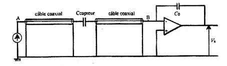
L'amplificateur opérationnel est supposé idéal et son fonctionnement est linéaire. Le générateur a des caractéristiques de Thévenin notées e(t) et  $R_q = 50 \Omega$ :
