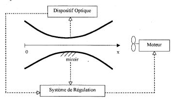
Sur ce schéma, les flèches en pointillés symbolisent les échanges d'information entre les différents éléments du système de régulation de la puissance du moteur.
