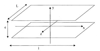
Les dimensions l et L étant très grandes devant la distance qui sépare les deux armatures, on négligera les effets de bords. On note Q la charge portée par l'armature supérieure et -Q celle portée par l'armature inférieure.
