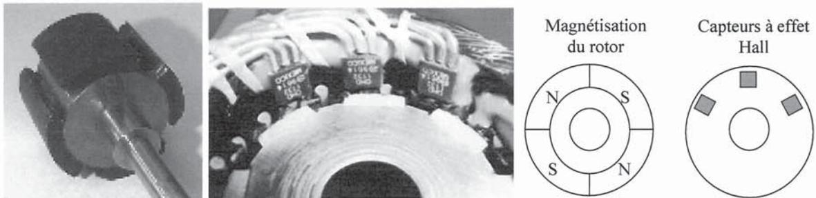
**Figure n° 2** – Emplacement des capteurs à effet Hall
