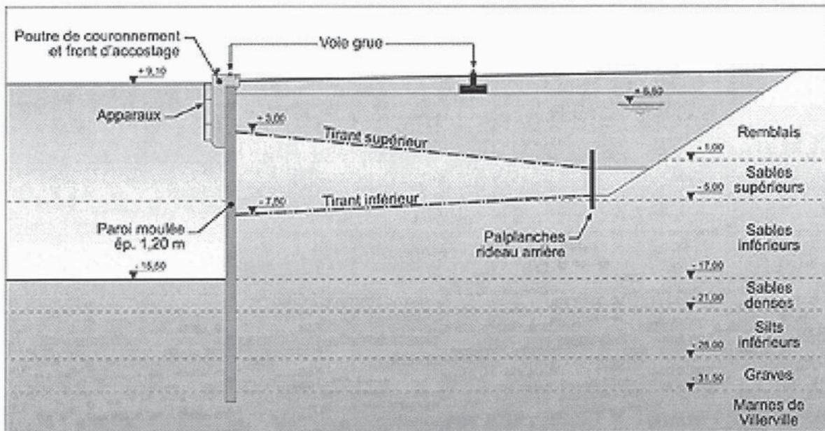
Figure 2 – Coupe type du quai dans sa configuration finale.
