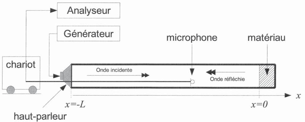
**Figure 2** – Schéma de la mesure du coefficient d'absorption d'un matériau avec la méthode du tube d'impédance (méthode du taux d'ondes stationnaires).
