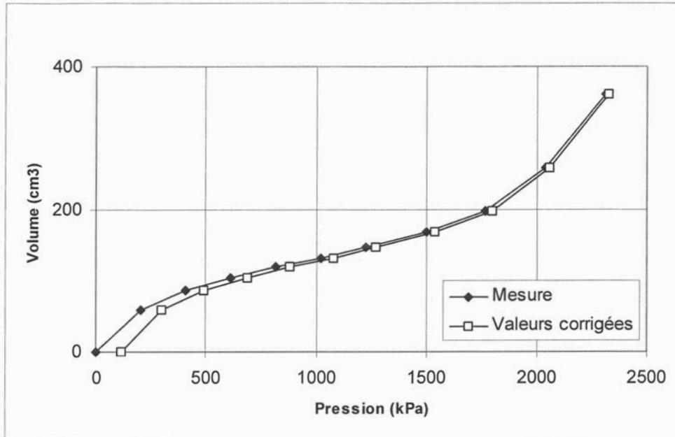
Figure 1 – Résultat d'un essai pressiométrique réalisé à la côte -8,00 CM.
