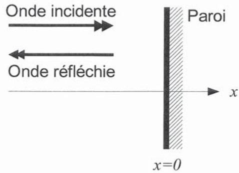
**Figure 1** – Réflexion d'une onde plane sur une paroi.
