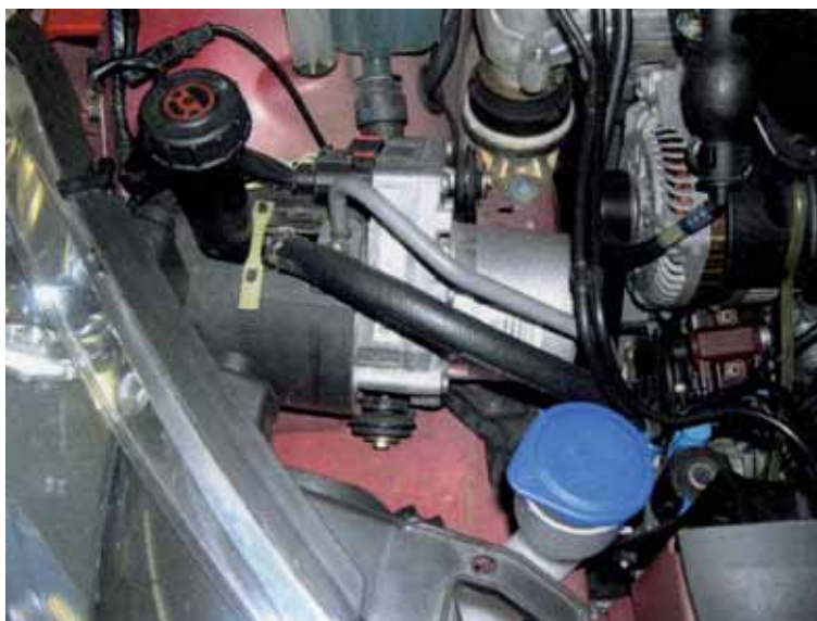
- Photographie du groupe électro-hydraulique étudié -
