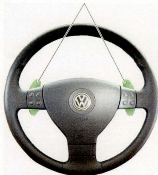
Commande de triptonic dans le volant de direction E389
