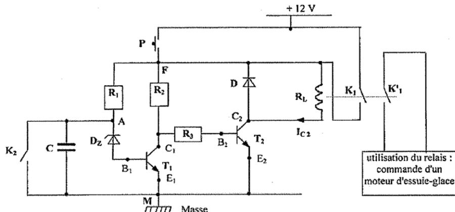
Ce circuit comporte un condensateur  $C$ , une diode  $D$ , une diode Zener  $D_z$ , un relais, des résistors et deux transistors bipolaires  $T_1$  et  $T_2$ .
