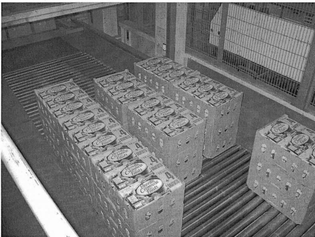
Les rouleaux sont entraînés en rotation par deux courroies situées sous le tapis qui viennent en contact ou non avec eux, sous l'action de mini-vérins pneumatiques.
