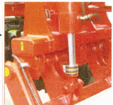
Détail d'un vérin hydraulique de levage et des butées de réglage de la profondeur de travail
