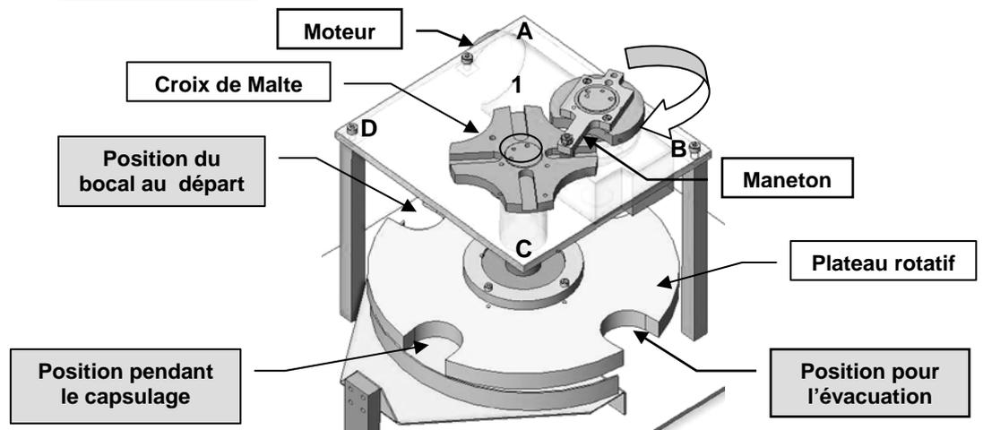
Position du mécanisme à différentes étapes de fonctionnement :
