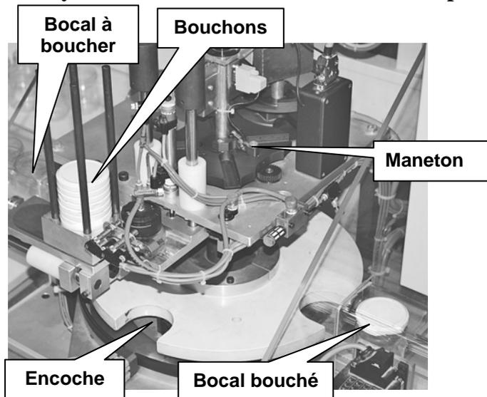
Un tapis roulant (non représenté sur la maquette) amène les bocaux remplis de confiture à gauche de la machine. Le premier bocal se bloque dans une des quatre encoches du plateau rotatif. Le maneton, entraîné par le moteur effectue un tour complet au cours duquel il s'engage dans une rainure de la croix de Malte.
