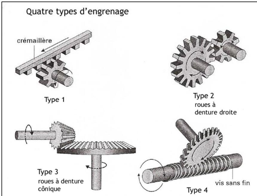
Un engrenage est un mécanisme composé de deux roues dentées mobiles autour d'axes de position relative invariable. L'une des roues entraîne l'autre par l'action des dents successivement en contact.
