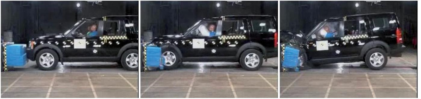
FIG. 10 – Séquence de crash-test frontal
