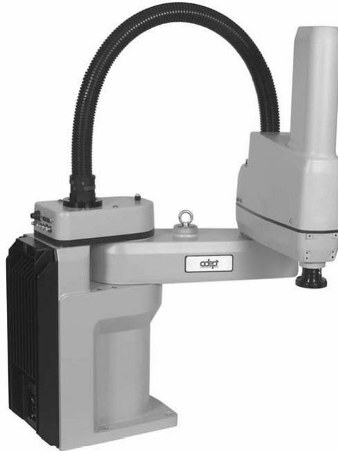
Figure 0.2 : Robot SCARA de conditionnement
